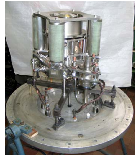
VHITAL-160 on HV flange
