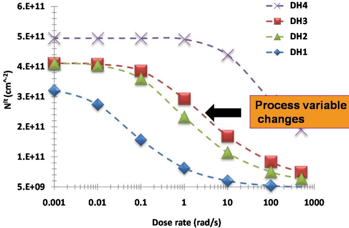
Fig. 9. Simulation of  $N_{it}$  formation as a function of dose rate for different hydrogen concentrations. In these simulations, there are  $DH4 > DH3 = DH2 > DH1$  and  $\sigma4 < \sigma3 < \sigma2 < \sigma1$ .
