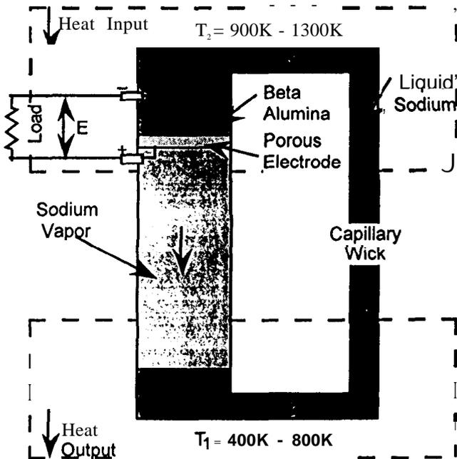
FIGURE 2: AMTEC OPERATING CYCLE
