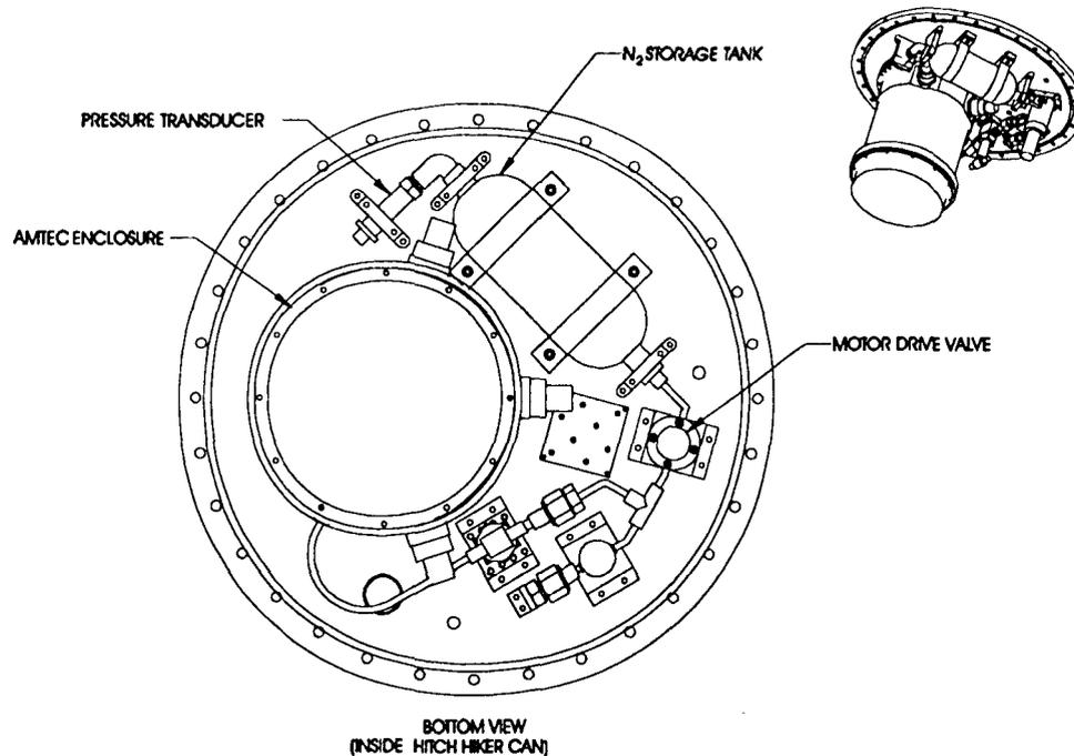
FIGURE 7: CHILL SYSTEM DIAGRAM
